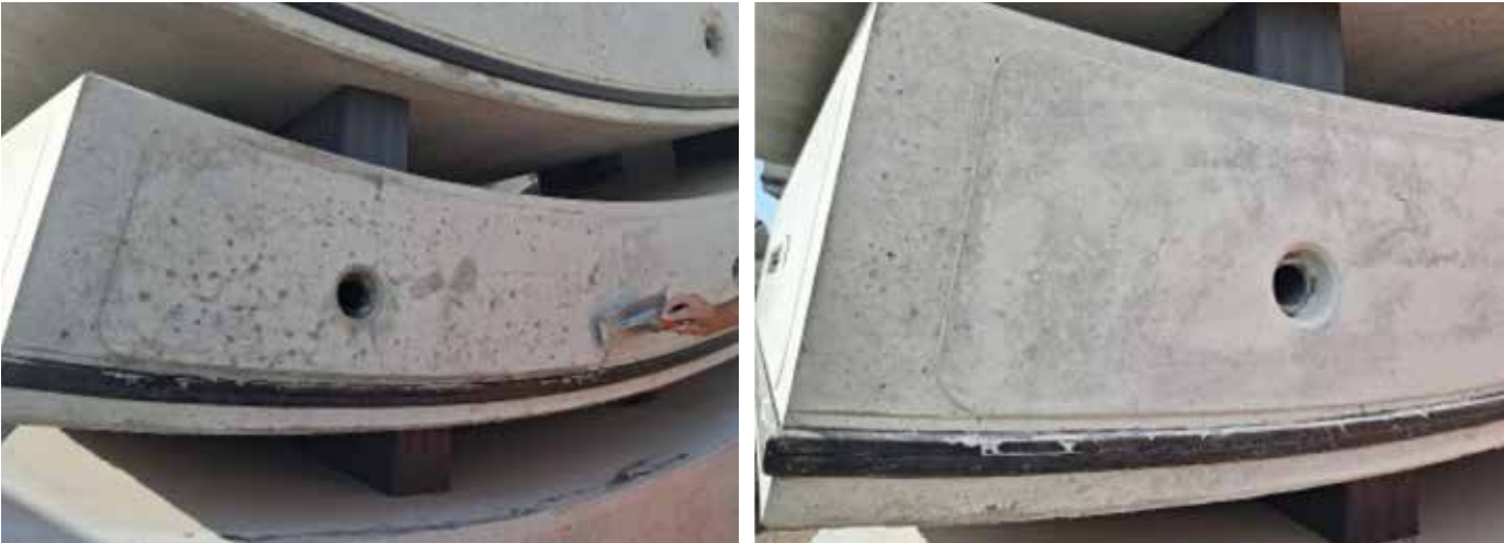
Fig. 5 Licata Finish Pro 280: Test applicativo per la rasatura dei conci
